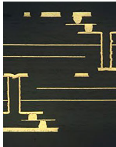
Figure 4: Resin fill—offset vias.
